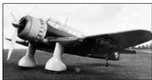
ANBO VIII – dvivietis vienmotoris lengvasis bombonešis, suprojektuotas konstruktoriaus Antano Gustaičio.
